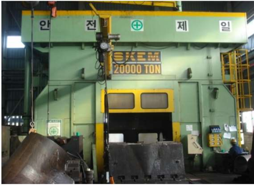
Tee Bulging Press 20,000 Ton
